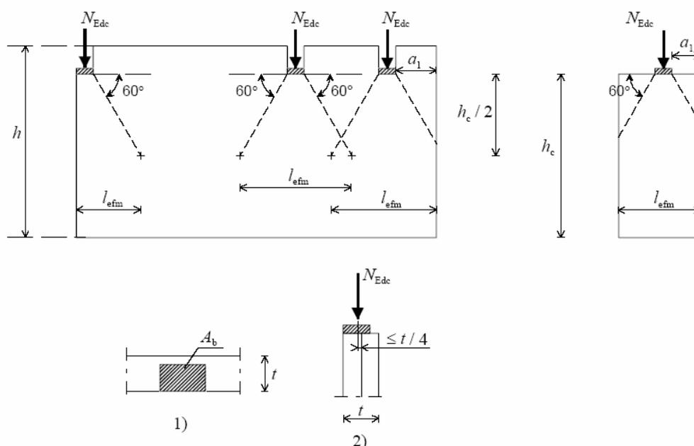
**Figura 5.4.1** – Pareti soggette a carichi concentrati. 1) pianta, 2) sezione
