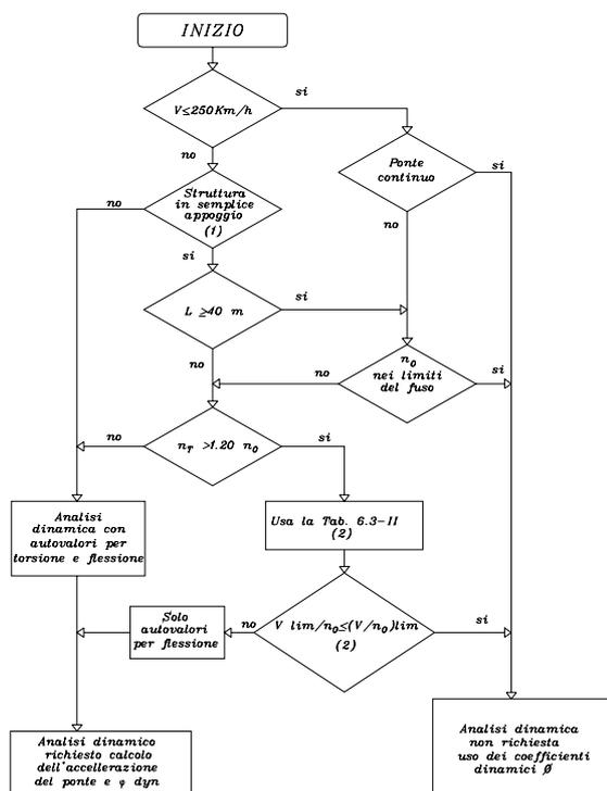
Fig. 6.3.8 – Diagramma di flusso
