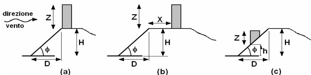
Figura 3.3.5 - Schemi di colline e pendii isolati
