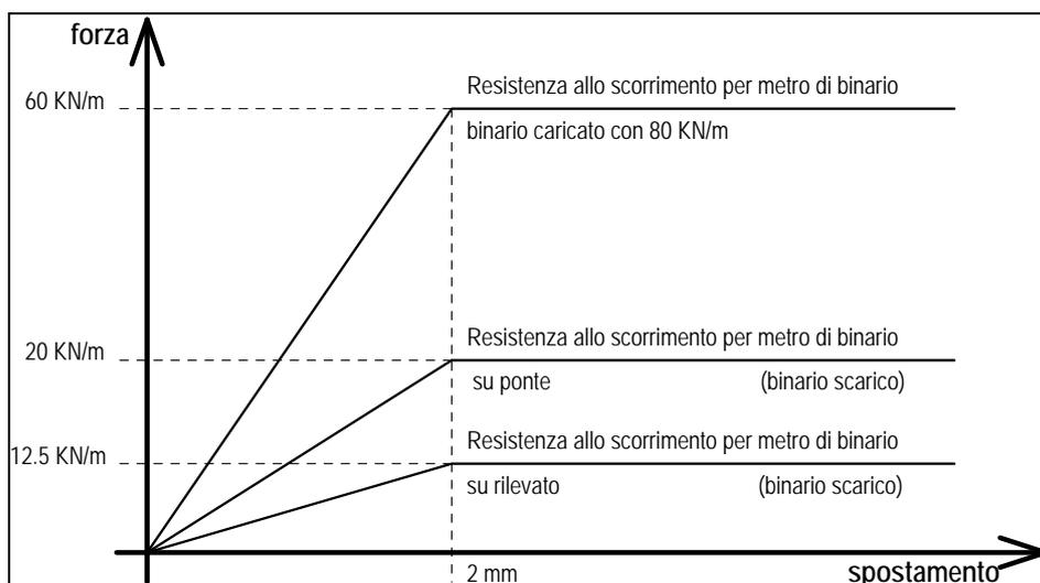
Fig. 6.3.9a - Legame forza-spostamento del ballast in direzione longitudinale.
