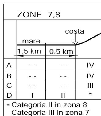
**Figura 3.3.3** - Definizione delle categorie di esposizione I, II, III, IV e V, in funzione delle regioni individuate nella macrozonazione
