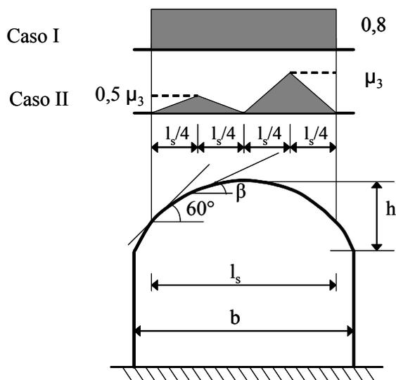
Figura 3.5.7 – Disposizioni di carico per coperture cilindriche
