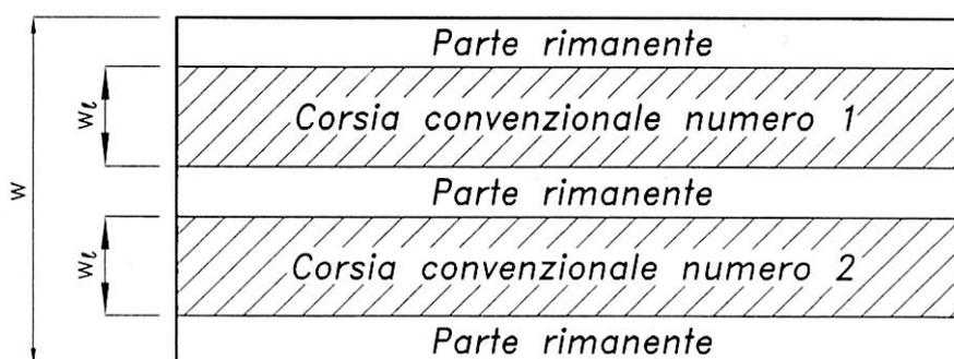
Figura 6.2.1 – Esempio di numerazione delle corsie
