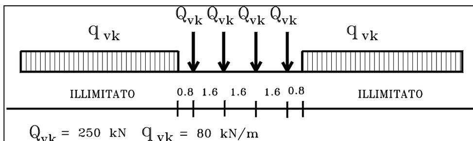
Fig. 6.3.1 - Treno di carico LM 71
