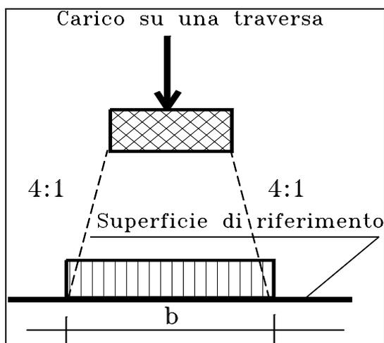
**Fig. 6.3.4** - Distribuzione longitudinale dei carichi attraverso il ballast.
