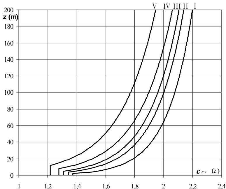
**Figura 3.3.4** - Variabilità con altezza e categoria del coefficiente di esposizione delle velocità  $c_{ev}$  quando  $c_t = 1$
