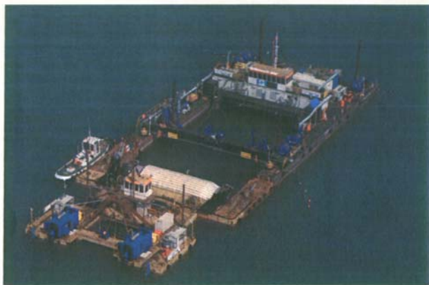
Mezzo in azione per la posa del materassino zavorrato
